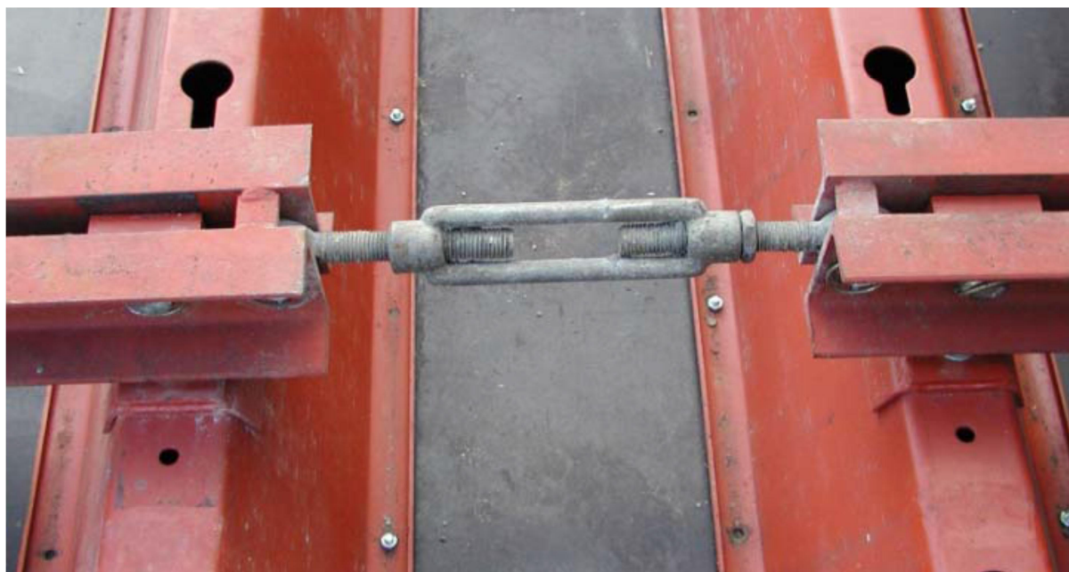
Afbeelding 8: voorbeeld van een spindel in bruikbare staat
