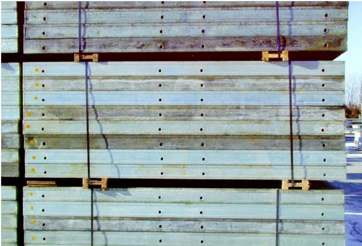
Afbeelding 3: voorbeeld van de voorgeschreven reinigingstoestand voor contactvlakken
