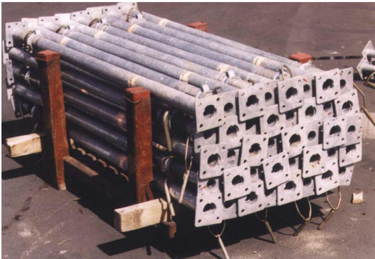
Afbeelding 10: gebruikte schoren, voldoen aan reinigingstoestand
