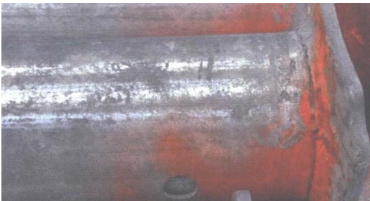
Afbeelding 13: ontoelaatbare scheur in lasnaad
