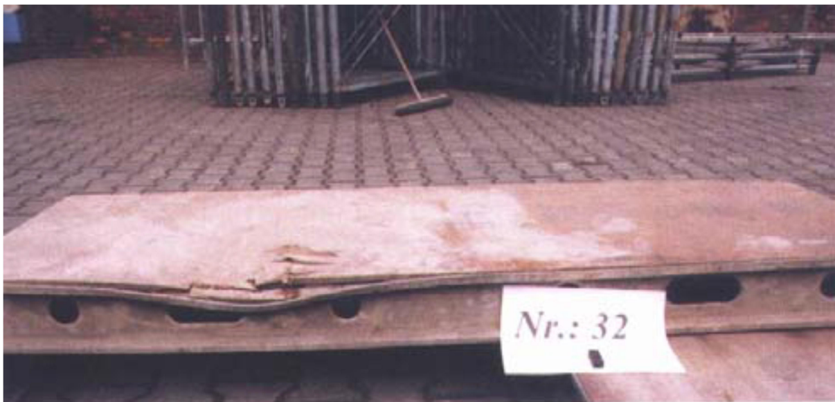
Afbeelding 20: ontoelaatbare beschadiging aan frameprofiel
