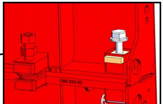
*Vérin de pied pour réglage de l'aplomb et vis de serrage pour l'assemblage avec centreur pour l'ajustement des faces coffrantes.*
