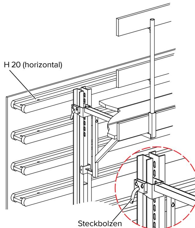
Bohlenabmessungen und Brettstärken für den Rückenschutz sind gemäß den Baustellengegebenheiten einzusetzen. Max. Abstand der Laufkonsolen: 1,50 m.
