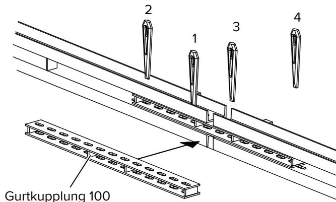
Gurtkupplung 100 möglichst mittig in die Stahlgurtung einsetzen und mit Keil 1 (möglichst nahe am Elementstoß), sowie Keil 2 (mit größt-möglichem Abstand) leicht anschlagen.
