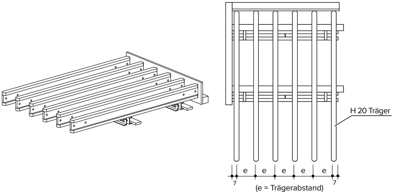
Befestigung des H 20 Trägers am Gurt mit der H 20 Trägerklammer.
