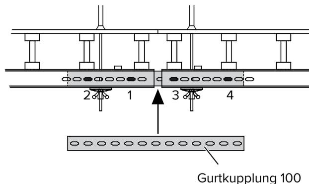
Keil 3 und Keil 1 festschlagen bis der Schalungsstoß dicht ist. Keil 4 und Keil 2 werden jetzt ebenfalls eingeschlagen.
