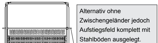
Zwischengeländer für Leitengang = Rohrriegel 48,3 x 3000 u. NK
