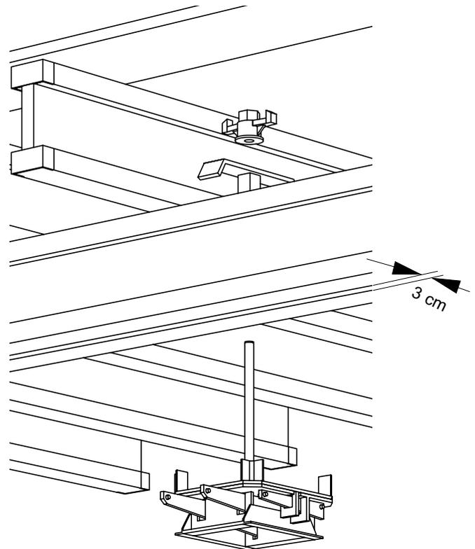
Der HT-Tischkopf kann an 8 cm breiten und bis zu 24 cm hohen Doppeljochträgern befestigt werden. Der Spalt zwischen den Holzträgern muß min. 3 cm betragen.
