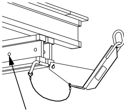
Der Anschluß erfolgt durch Abstecken an der inneren Bohrung des Jochträgers.
