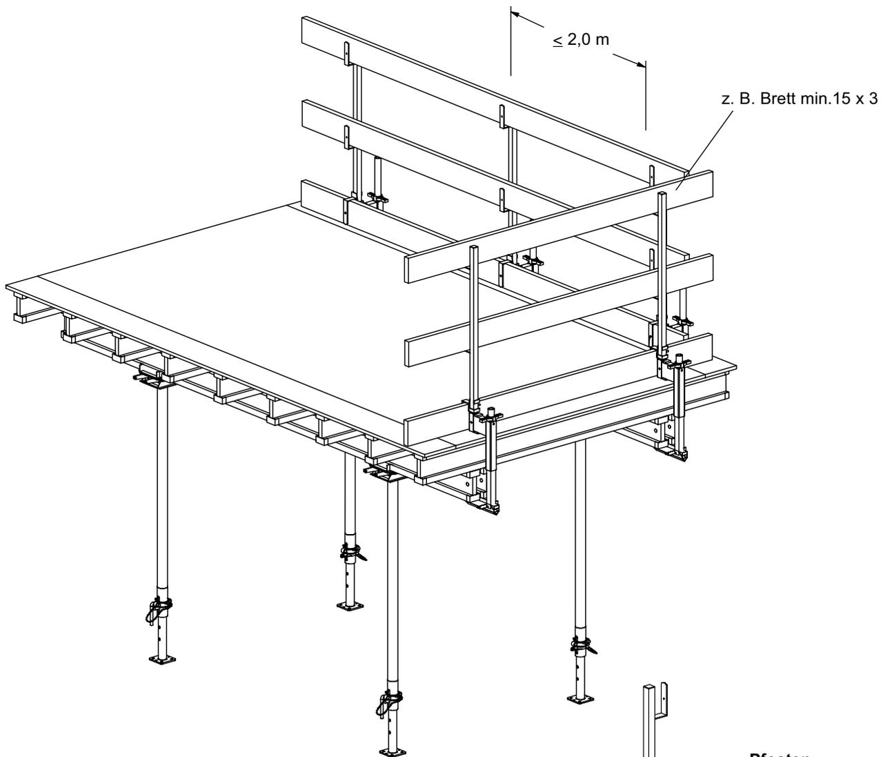
An der Tischkante (Längs- oder auch Kopfseite) ist dafür die Multizwinge zu montieren.
