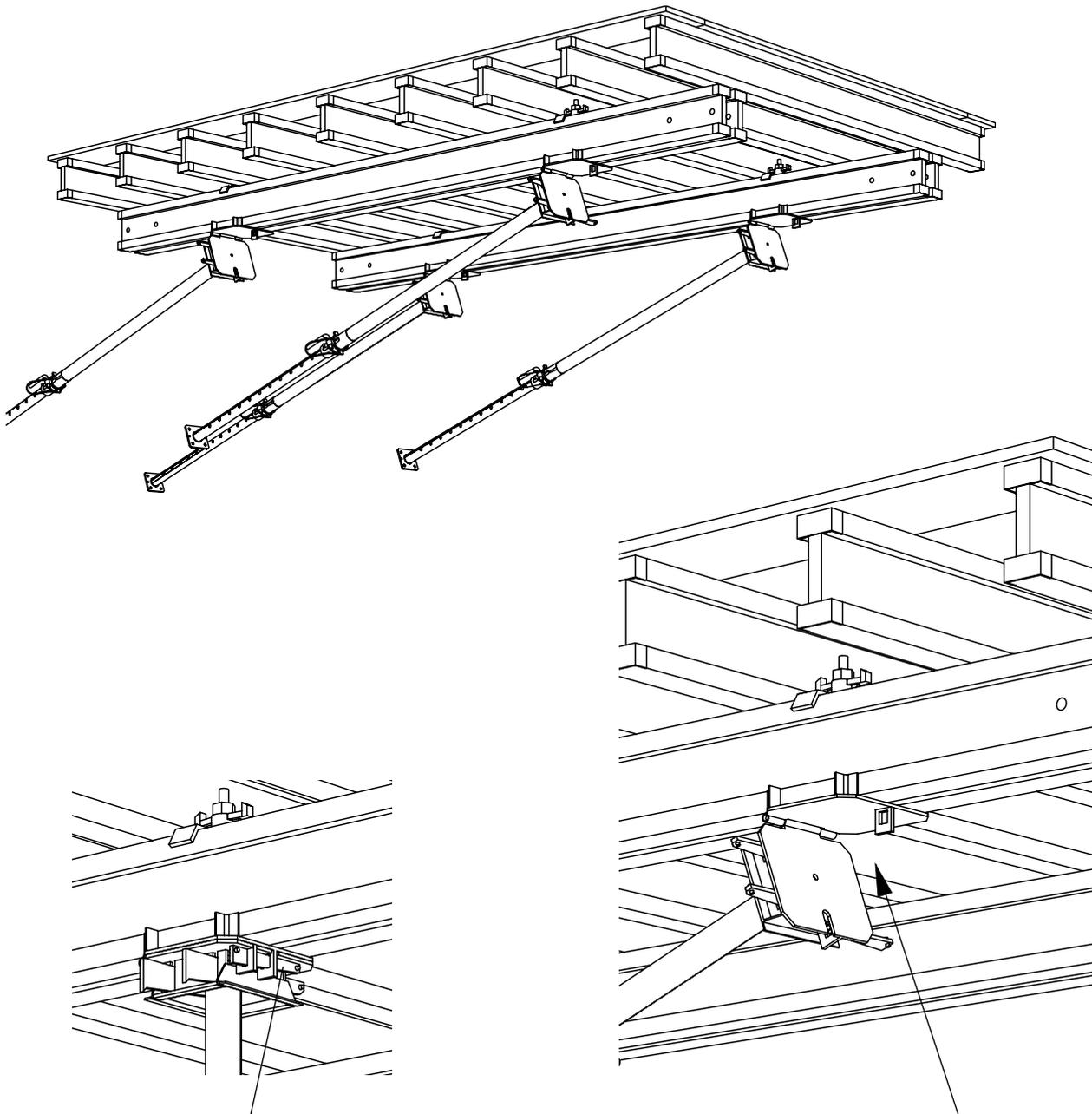
Durch Öffnen dieses Keilverschlusses wird das Gelenk des Tischkopfes frei.
