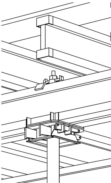
Durch das gleichmäßige Eintreiben der beiden Stahlkeile erfolgt eine sichere und steife Verbindung zwischen Tisch und Stützen.
