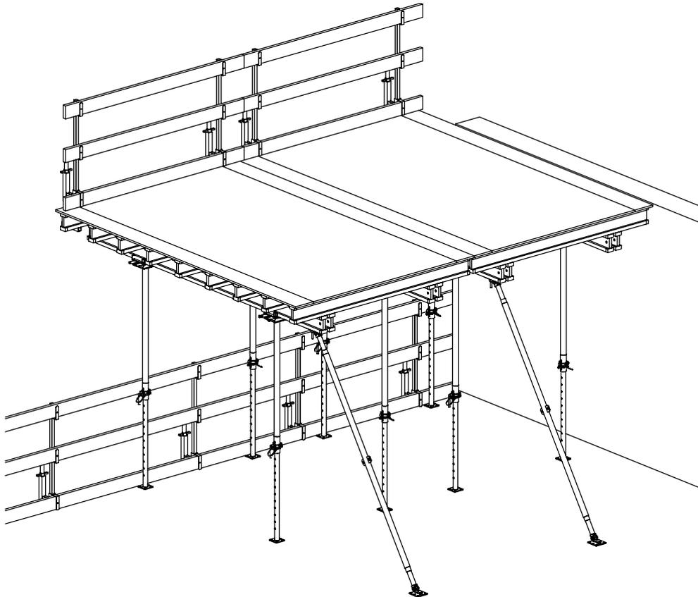
Die mit zwei Gelenkplatten ausgestattete Wandstrebe sorgt für eine zug- und druckfeste Abspannung der Randtische. Die Wandstreben mit einem Spindelweg von 70 cm stehen in einem Längenbereich von 2,70 m bis 5,90 m zur Verfügung.
