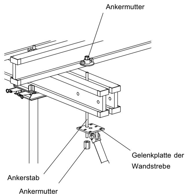
Die dargestellte Stabilisierung ersetzt nicht die erforderliche horizontale Aussteifung der Deckentische vor dem Betonieren.
