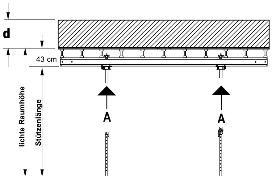
Die Angaben gelten für ein in Schalungsebene gegen tragsichere Bauteile verkeilt und damit unverschiebbar gehaltenes System.
