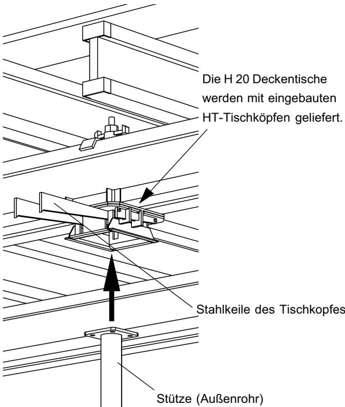
Die Fußplatte der Stahlrohrstütze ist in die Aufnahme des Tischkopfes zu führen. Dabei wird sie durch einen Zapfen zentriert.
