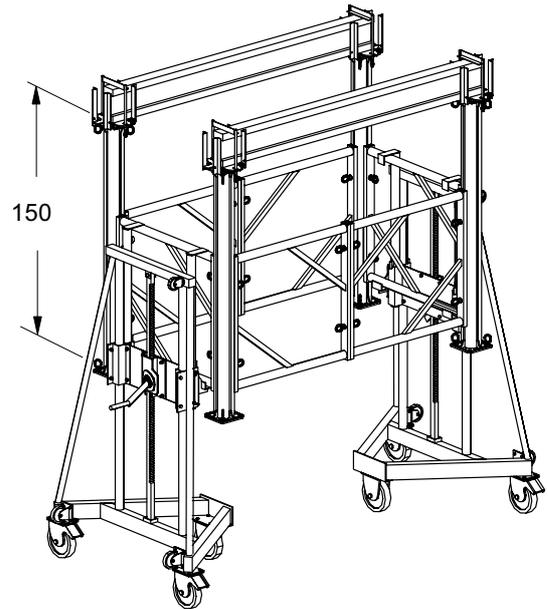
Für das Verfahren und Umsetzen der H 20 Deckentische wird der Wagen mittig unter dem noch eingeschalteten Tisch positioniert. Über die beiden Winden ist die Tragkonstruktion des Wagens auf Kontakt zum Tisch zu bringen. Die Stützen des Tisches mittels Schnellabsenkung ausschalen und die Innenrohre einschieben. Der nun auf dem Fahrwagen liegende H 20 Deckentisch kann abgesenkt und umgesetzt werden.
