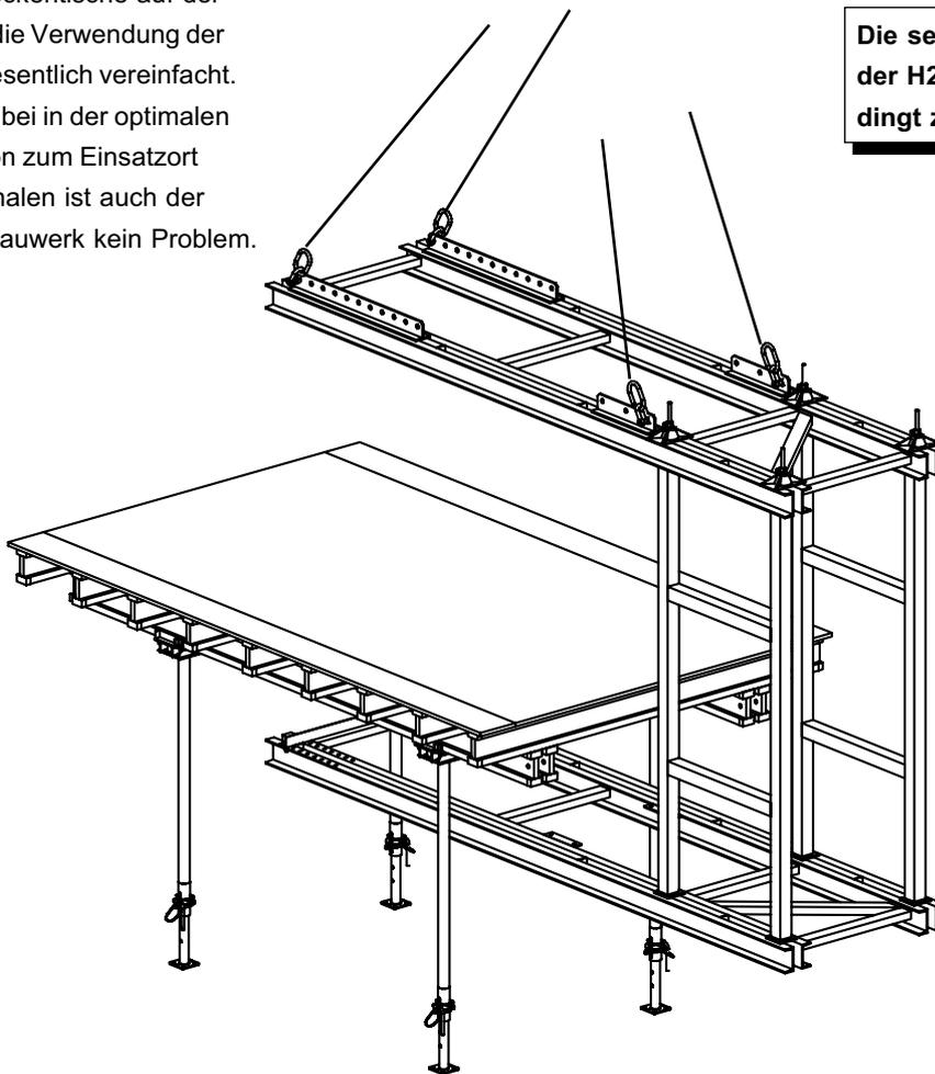
Die Breite und Länge der H 20 Umsetzgabel ist auf die Größe der Deckentische abgestimmt. Der Tisch kann sowohl von der Kopf- als auch von der Längsseite aufgenommen werden. Die optimale Schwerpunktslage wird durch die Anschlagpunkte der Kranseile bestimmt, die durch einen Hebeversuch auf der Baustelle zu ermitteln sind.
