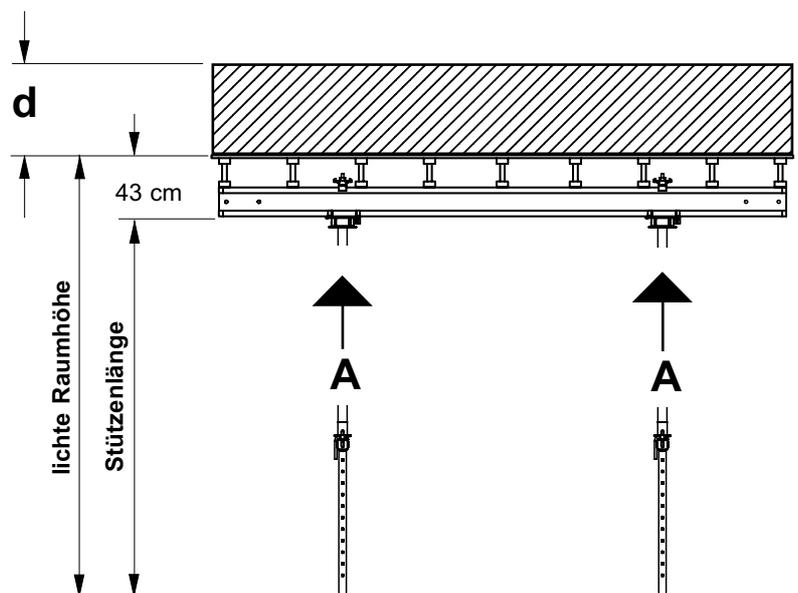
Die Angaben gelten für ein in Schalungsebene gegen tragsichere Bauteile verkeilt und damit unverschiebbar gehaltenes System.
