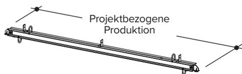
Der Klinkbühnenträger ist nicht verstellbar und wird für die entsprechende Anwendung produziert. Tragendes Bauteil einer Schachtbühne. Mit gelenkigen Auflagern, die beim Umsetzen mit dem Kran selbsttätig einrasten. Der Holzaufbau und der Bohlenbelag der Bühne sind bauseits zu stellen.
