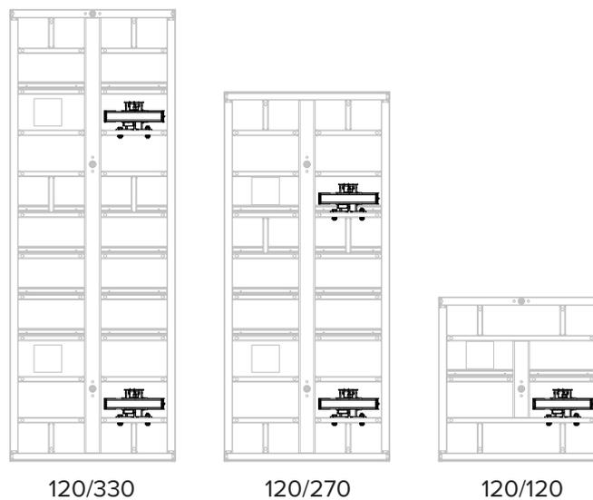
**Schritt 1** Tafelverbindungseinheit (Art.-Nr. 609080) mit den mitgelieferten Schrauben und Muttern am Riegel der Tafel zu montieren.
