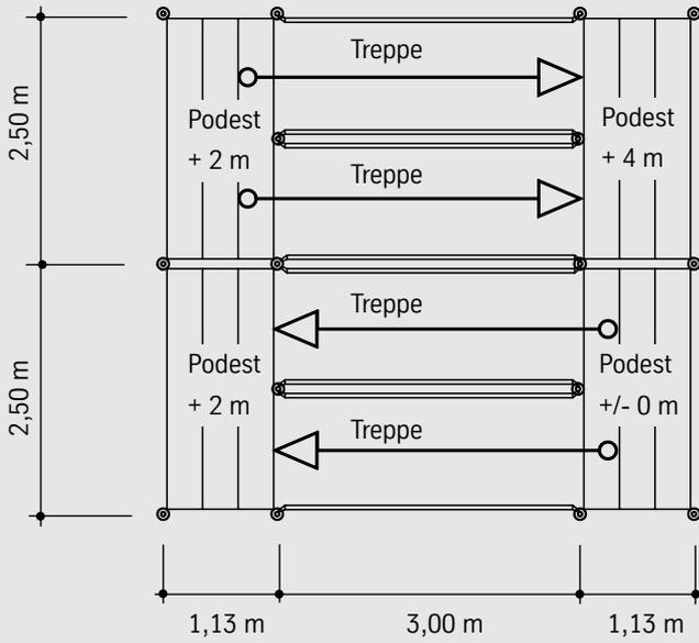
**Treppenaufbau-Variante bei  $p=5\text{ kN/m}^2$  über 16 m Höhe**
