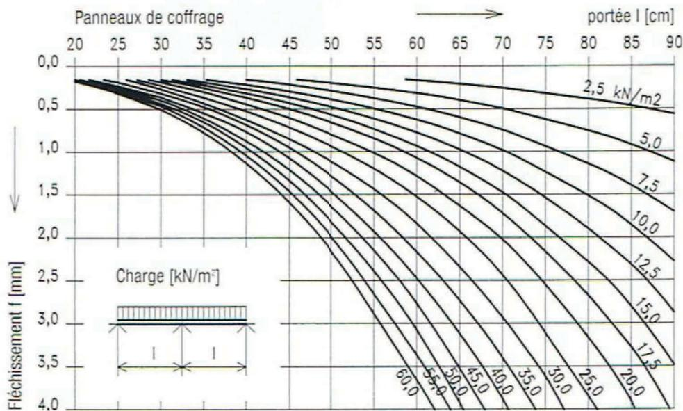
Les valeurs de fléchissement ont été relevées sur la base d'essais pendant lesquels les panneaux sont restés dans l'eau avant 24 heures. Les fibres des couches de recouvrement sont orientées verticalement par rapport aux supports.
