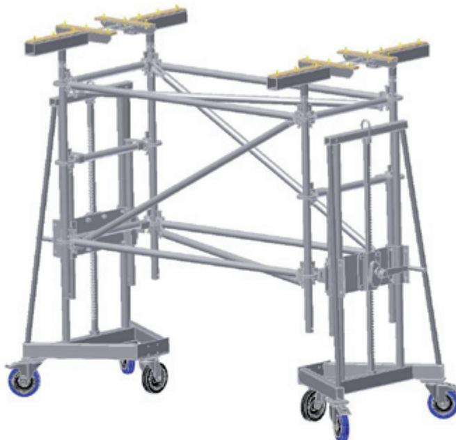
Pour déplacer par roulement les **tables coffrantes TOPMAX**, positionner le chariot au milieu de la table TOPMAX encore coffrée. En actionnant les deux crics à crémaillère, amener le système porteur du chariot en contact avec la **table coffrante TOPMAX**.
